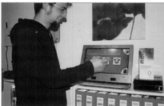
auch den Prototyp eines eHome-Systems von CEIT Raltec austesten, wie es Diplomingenieur Josef Diermaier auf dem Touchscreen mit einfachen Interface-Design gerade vorzeigt. Das kleine schwarze Kästchen ist die "Home Control Unit", die das gesamte eHome-System vernetzt und regelt.
